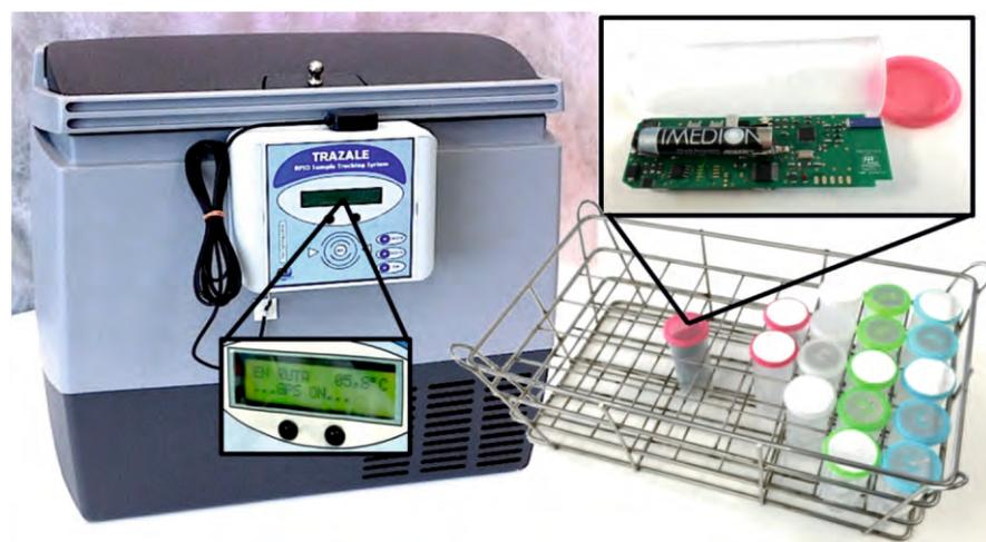
**Figura 2.** Sistema integral inalámbrico de trazabilidad para el proceso de recogida de muestras.
