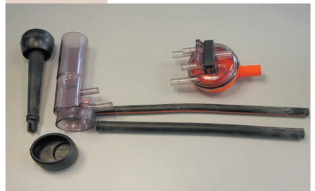
Figura 7. Despiece de un juego de ordeño con válvula automática en la pezonera y con colector.
